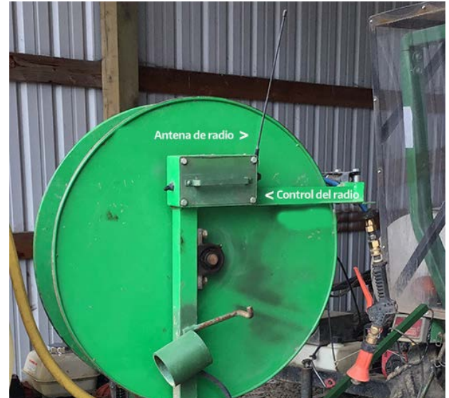
Radio control instalado en el carrete portamangueras.
