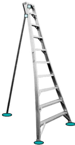
plataformas, muchos continuarán necesitando el uso de escaleras. El prototipo final que esta actualmente a prueba es el de una nueva “escalera inteligente” con sensores que provee información sobre las fuerzas dinámicas que llevan a las caídas. La escalera puede ser equipada con señales de advertencia para acostumbrar a los trabajadores a los límites de estabilidad de las escaleras de tres patas. Esto ayudará a los trabajadores a entender cuales actividades peligrosas deben evitarse.
